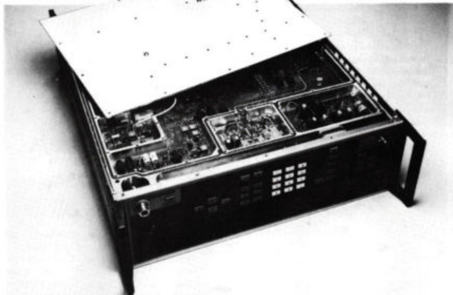
Afb. 8. Alle schakelingen van de 6060A zijn ondergebracht in een uit één stuk vervaardigd metalen binnenhuis waarin een horizontale chassisplaat en ook diverse afschermcompartimenten zijn geïntegreerd. Gaten met geleidende pakking geven een effectieve afdichting van de naden tussen huis en metalen deksel.
