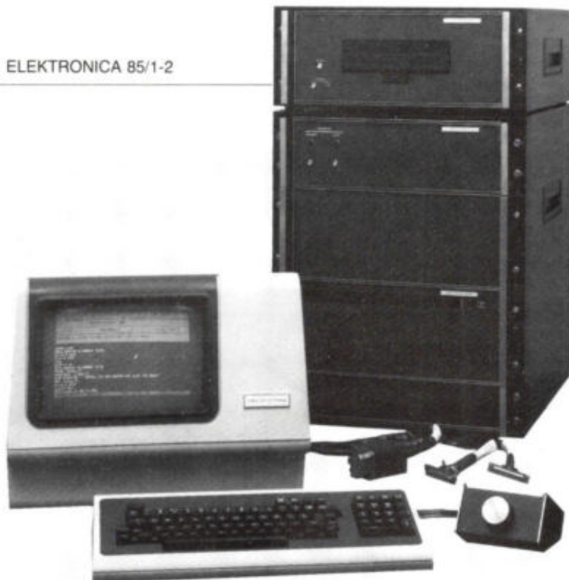
Afb. 6. Gecomputeriseerde beproevingsopstelling CTS-81 van Collins, ontwikkeld voor het beproeven van de elektronische uitrusting van Rockwell's B-1B bommenwerper.
