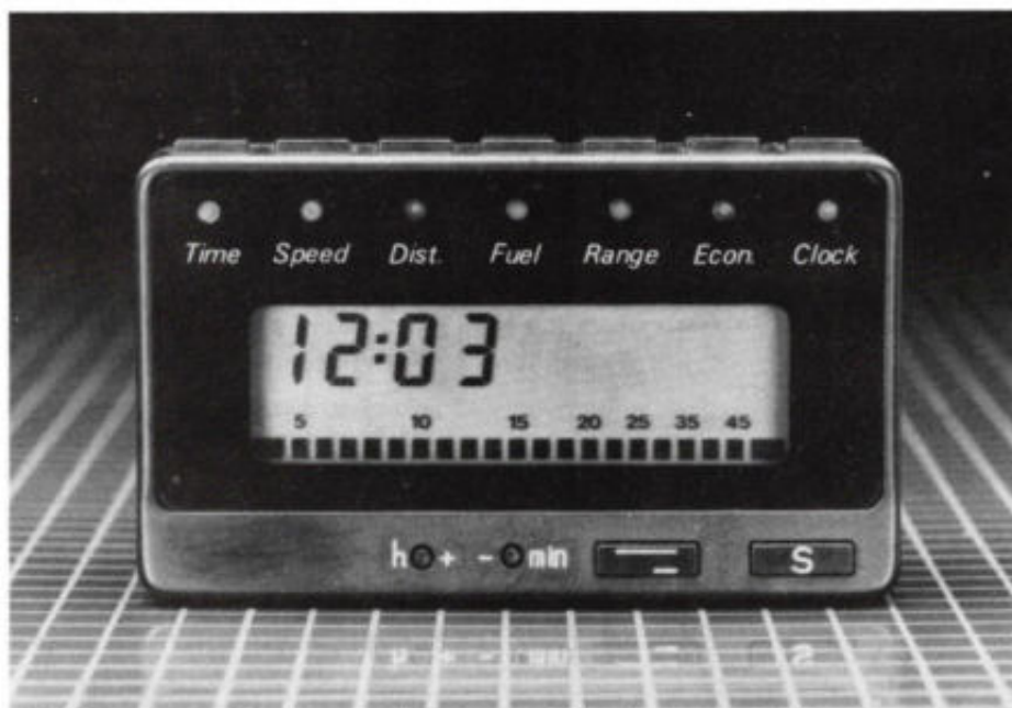
De K3 computer van Zemco met onder meer een LC-display en een staafdiagram voor brandstofverbruik.
