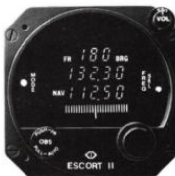
Afb. 5. EscortII is de benaming van deze volledig digitale NAV/COM-set met een geïntegreerde CDI (Course Deviation Indicator) van Narco Avionics.
