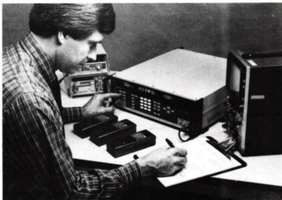
Hoogfrequent-signaalbronnen, zoals deze zojuist door Fluke geïntroduceerde synthesesegenerator, zijn altijd onmisbare instrumenten geweest bij het verrichten van controles en afregelingen aan radio-ontvangers.
