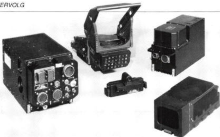
Afb. 1. De verschillende componenten van het navigatie- en weergeefstelsel dat Ferranti in samenwerking met Construcciones Aeronauticas S.A. ontwikkelde voor de nieuwe Aviojet straaltrainers van de Spaanse luchtmacht. Middenboven is de Head-Up Display (HUD) te zien, waaronder de videocamera voor de voorste cockpit. Links daarvan is de HUD afgebeeld; rechtsboven bevindt zich de referentie voor het traagheidsnavigatiesysteem. De module rechts op de voorgrond is de monitor voor de instructeur.
